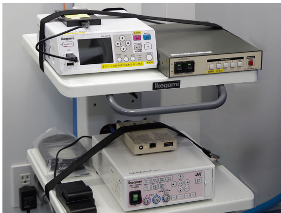
手術室のワゴンに設置したMKC-704KHDのカメラコントロールユニットとデジタルレコーダーMDR-600HD
