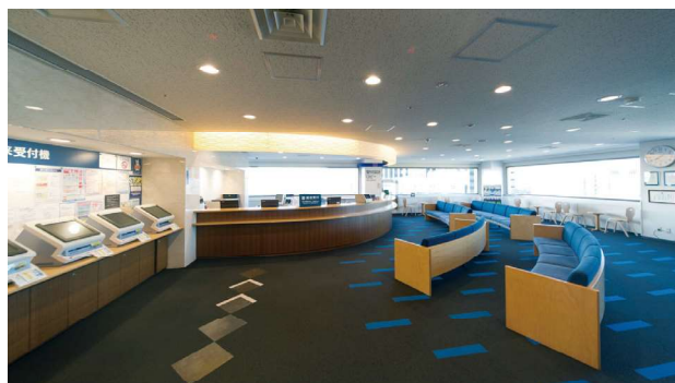
受付会計ロビー 各フロアでは導線を考えて、通路部分に足裏の感触でもわかる菱形のタイルを埋め込み順路をお知らせしています。濃いグレーの床は落とす物も探しやすく、ゾーン毎で床模様を変える工夫もされています。
