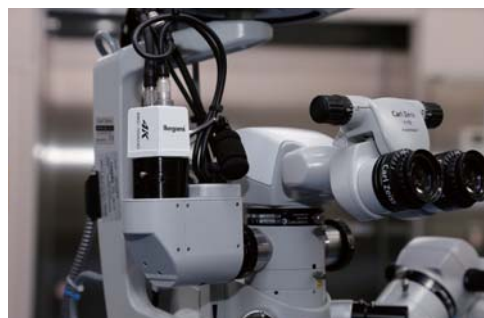
手術顕微鏡に取り付けられたMKC-704KHDのカメラヘッド
