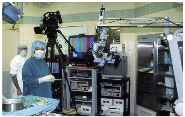
3DカメラLKシリーズ：アームに2台の小型カメラヘッド(銀色)を搭載
