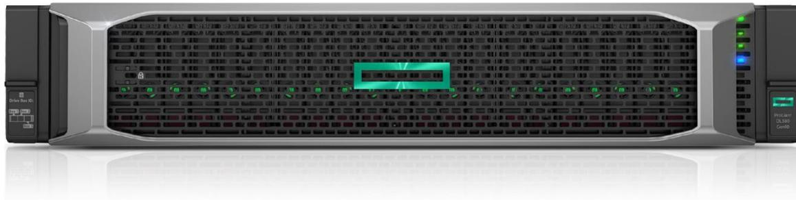
**Spectrum™ MediaDirector 2252C-DS システムコントローラーは Harmonic の Spectrum メディアサーバーシステムの中核であり、Spectrum メディア I/O モジュールおよび MediaStore 5100 ストレージレイとの間のデータフローをアクティブに管理します。**
