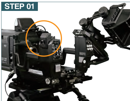
STEP 01 SE-H750のロックを外し、VF部分をスライドします。
