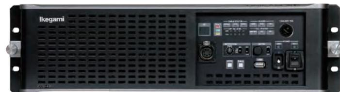
UHK-430/435のカメラコントロールユニットです。ファイバケーブルを使いカメラとの映像、音声、コマンド信号の伝送や、カメラへの電源供給を行います。4K、HDの信号に対応しているため、HDから4K制作へのスムーズな移行をサポートします。カメラ-CCU間は最大10km延長が可能です。
