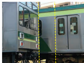
全局快门没有滚动快门的失真缺陷
