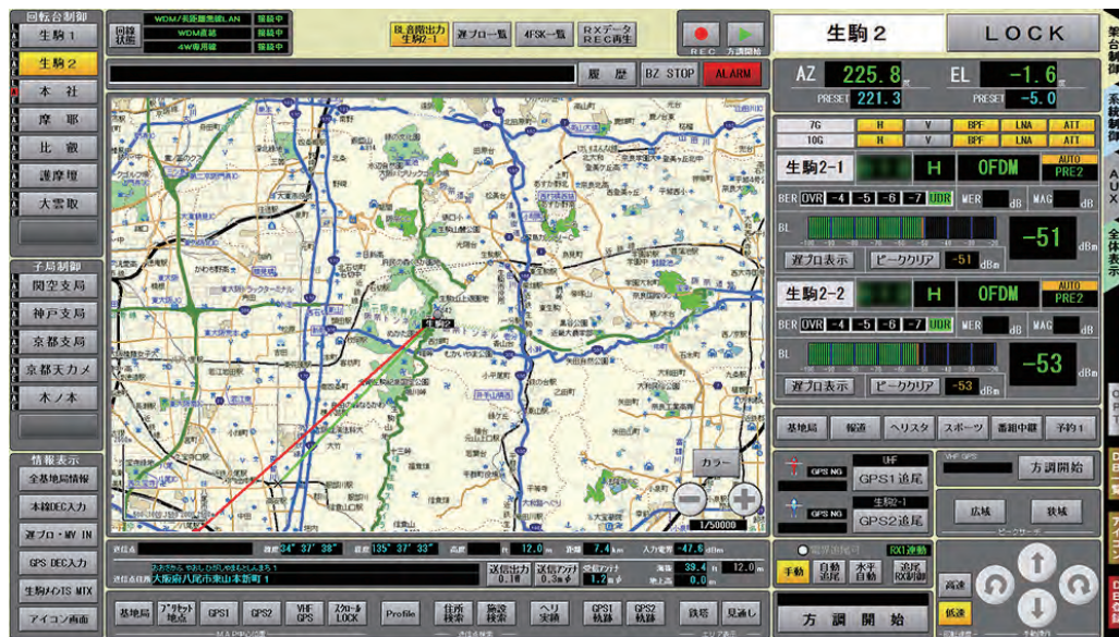
地図：MapDK5 (C) INCREMENT P CORPORATION 生駒第2基地局 受信架台制御画面
