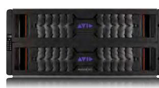
大規模の放送局や制作 / ポストプロダクション環境向けの、エンタープライズレベルのストレージ・エンジンで、最高レベルの拡張性、性能、クライアント接続性を提供。外部 System Director Appliance が必要です。
